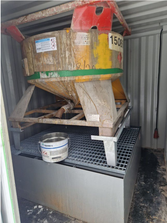
Kuva 2: Teräksinen 500 l ohennesäiliö
